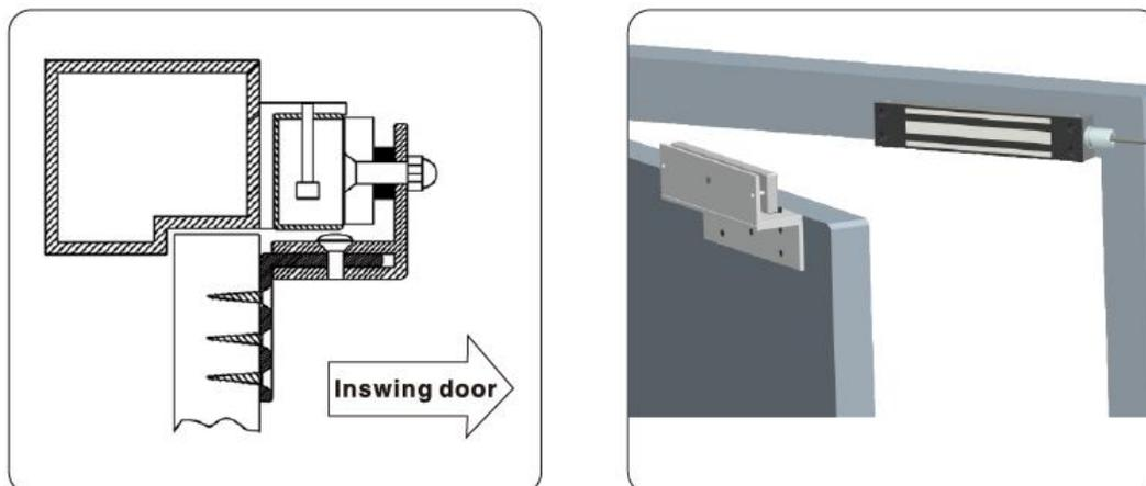
Paso 1: Debe haber 2 arandelas de metal y arandela de goma entre la placa y el soporte en forma de Z. Poner la arandela de goma entre 2 arandelas de metal. Bloquee el tornillo superior plano en el centro de la placa a la placa en forma de Z.
