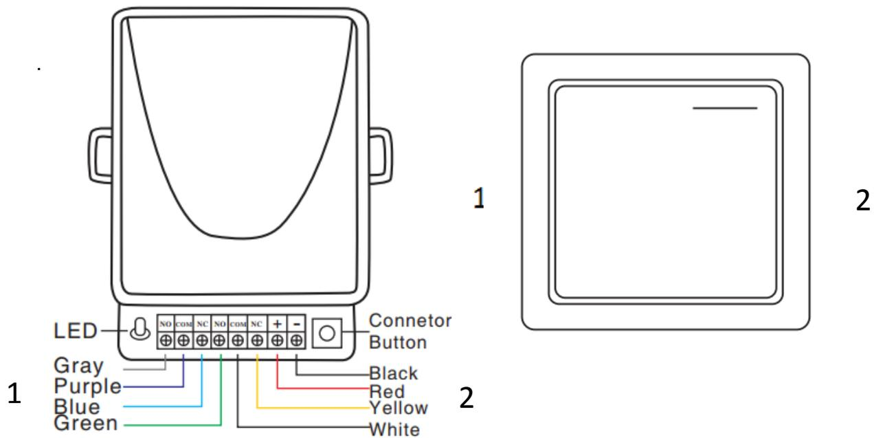
El dispositivo cuenta con dos botones los cuales accionan de manera independiente cada salida de relevador (1,2) del receptor (PROR400). Para enrollar el botón del transmisor (PROB400) es necesario presionar el push button que se encuentra en el receptor (PROR400) el led encenderá de manera momentánea, lo siguiente es presionar cualquier lado (1,2) del transmisor (PROB400) el LED del receptor (PROR400) destellara indicando el correcto enlace.
